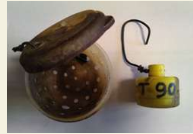
Sonde enregistreuse (thermographe) et mise en place sur les cours d'eau du bassin du Viaur
